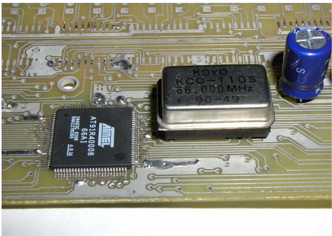
Для отладки и тестирования работы контроллера, была создана отладочная плата. При помощи этой платы можно отлаживать работу контроллера с внешней оперативной и внешней Flash памятью. Также есть возможность подключать PC через UART.
